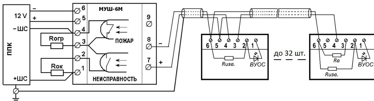
$R_{изв}$  равно 510 Ом,  $R_{в}$  равно 2,4 кОм
