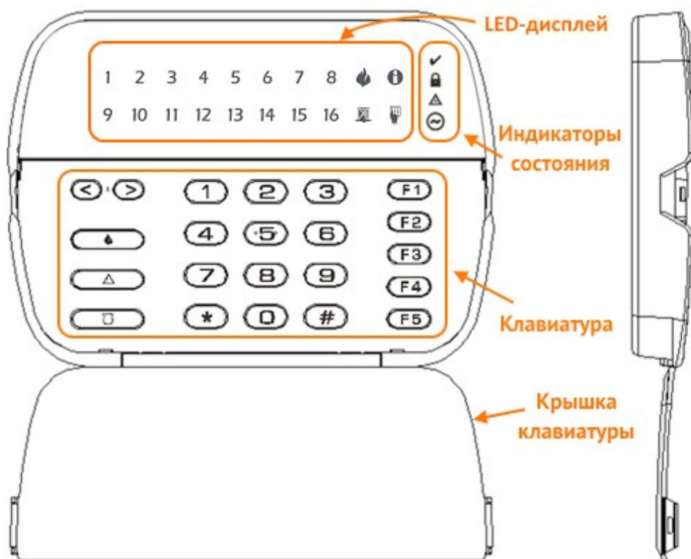
Рисунок 1. Внешний вид УИУ "Линд-11LED" с открытой крышкой
