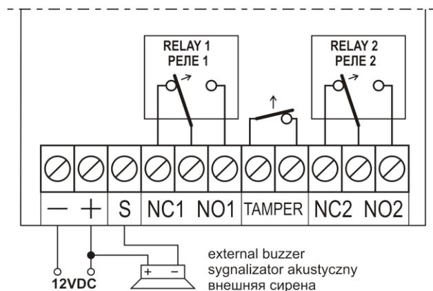
**ВАЖНО! Сигнальный выход S не должен подключаться напрямую к (+) источнику питания (см. схему).**
