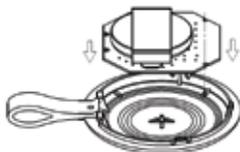
3. Установите нижнюю крышку корпуса, в соответствии с вырезом ремешка, со смещением на 1,5 мм. Прижмите крышку у ремешка и сдвиньте ее вниз. Далее, осторожно нажимая на крышку, закройте корпус брелока.
