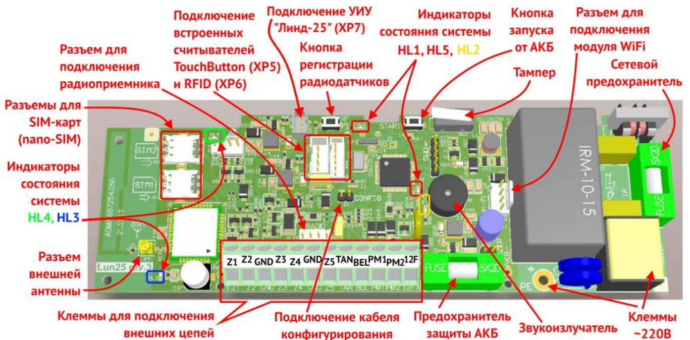
Рисунок 4. Расположение элементов на плате ППКОП
