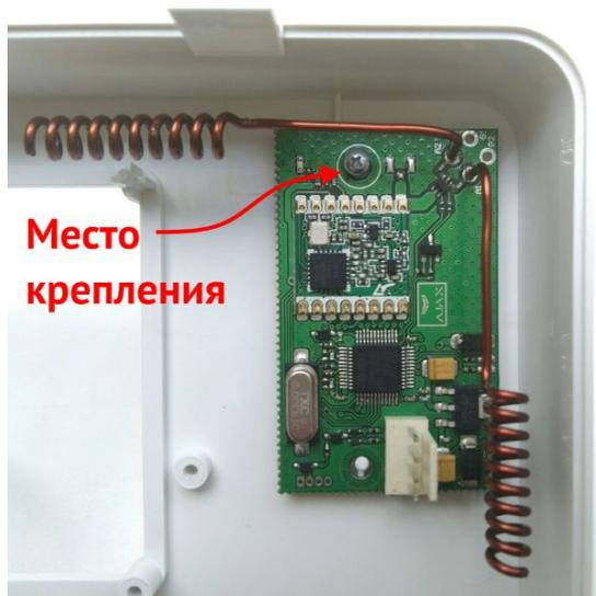
Рисунок 20. Радиоприемник Ајах «uartBridge» в корпусе
