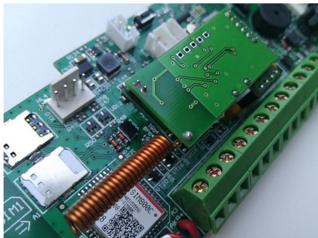
Рисунок 19. Радиомодуль «Адаптер L25-Rielta» на плате ППКОП
