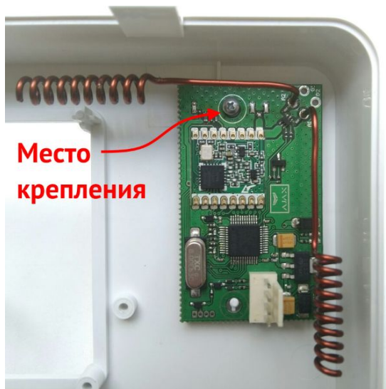
Рисунок 20. Радиоприемник Ајах «uartBridge» в корпусе
