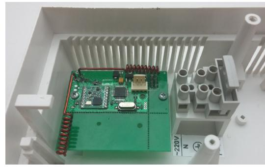
Рисунок 31. Радиоприемник Ajax «uartBridge» в корпусе прибора
