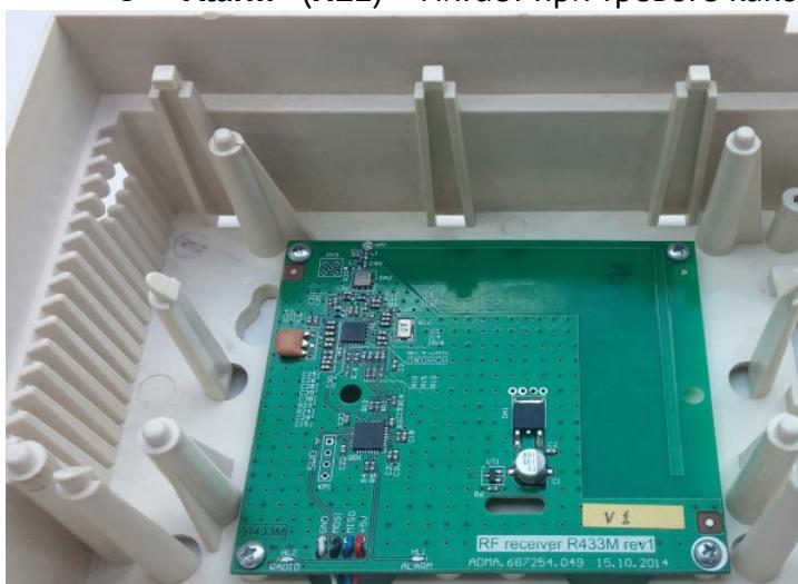
Рисунок 20. Радиоприемники серии «P433» в корпусе прибора
