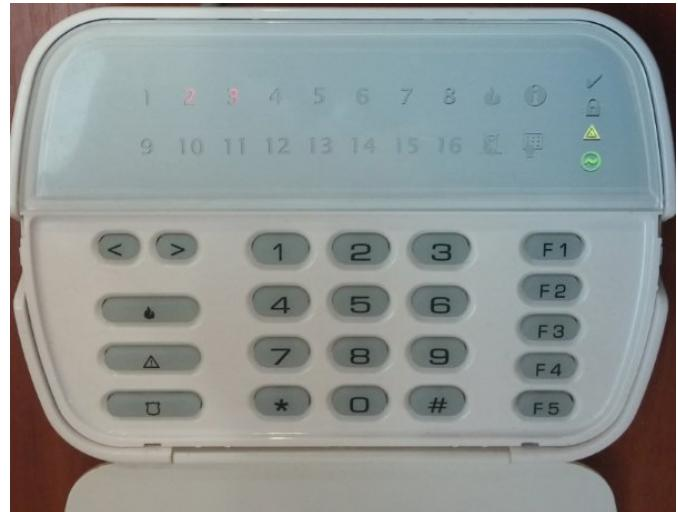
Рисунок 16. Внешний вид УИУ «Линд-11LED» с откинутой крышкой
