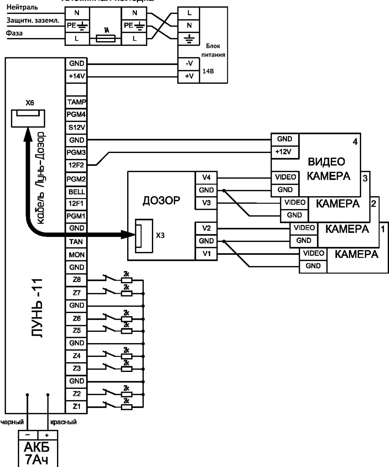
Рисунок 44. Схема подключения модуля фотоподтверждения тревог «Дозор»
