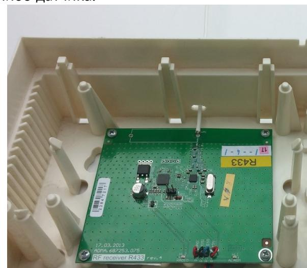
Рисунок 21. Радиоприемник «P433» rev.4 с антенной в корпусе прибора
