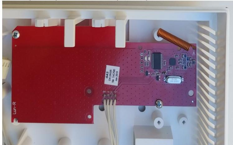
Рисунок 19. Радиоприемник "Lun-R" в корпусе прибора
