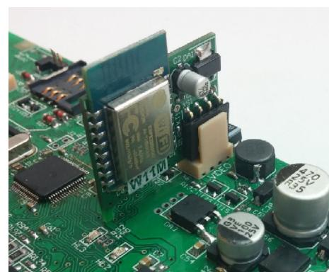
Рисунок 38. Установка модуля «W11M» в X6
