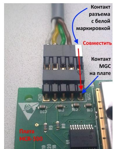
Рисунок 24. Подключение радиоприемника Visonic
