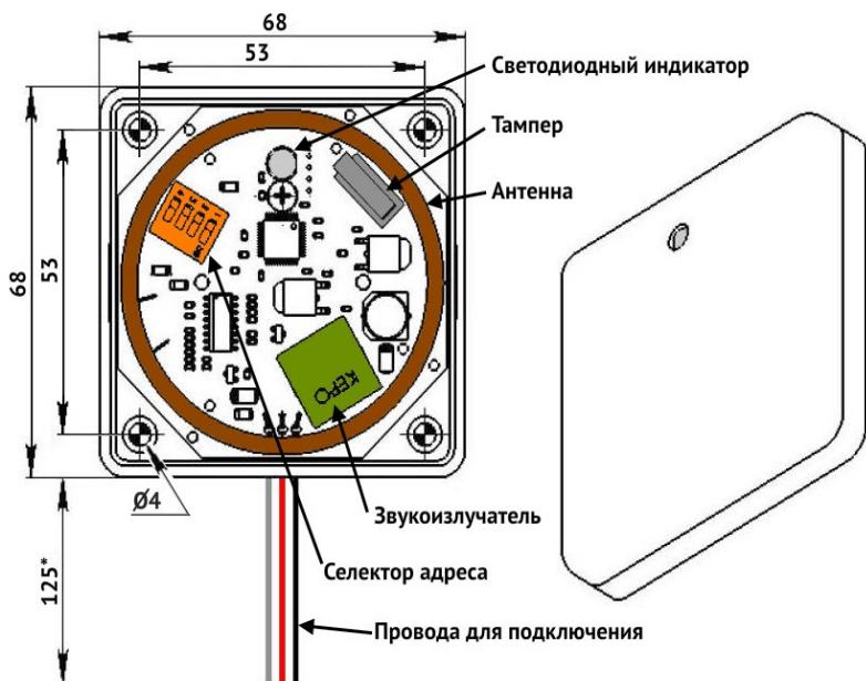
Рисунок 12. Внешний вид и устройство УИУ «Линд-ЕМ»
