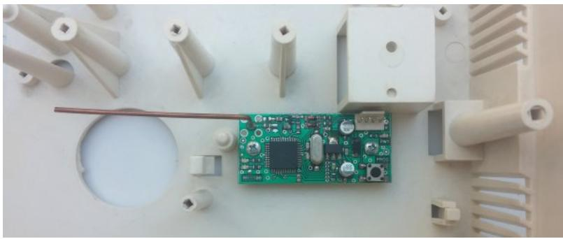
Рисунок 30. Радиоприемник Ajax «RR-108» в корпусе прибора
