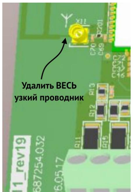
Рисунок 6. Подготовка платы ревизии 19 для подключения внешней антенны
