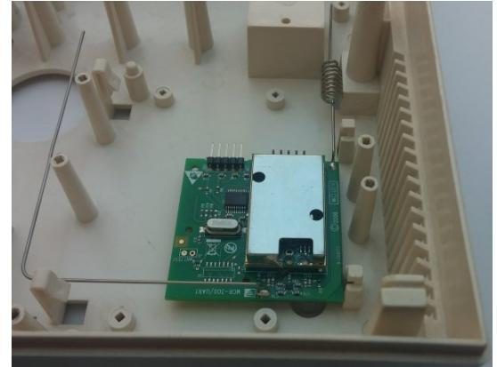
Рисунок 23. Радиоприемник «MCR-300» Visonic в корпусе прибора
