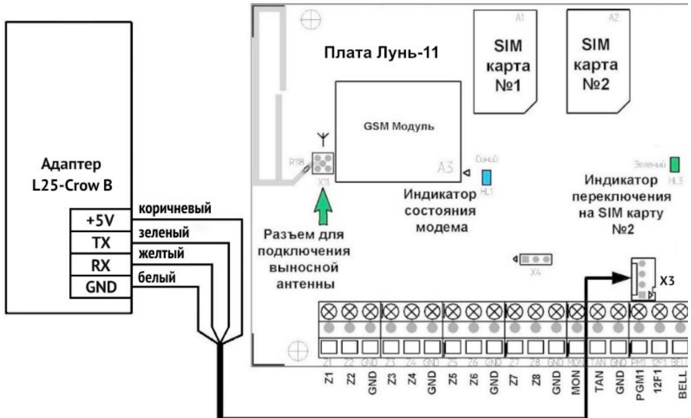
Рисунок 47. Схема подключения адаптера «L25-Crow В»
