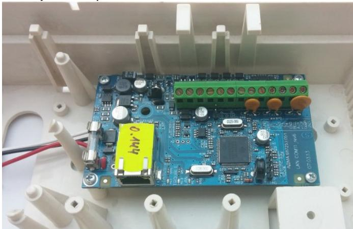
Рисунок 32. Коммуникатор «LanCom» rev.15 в корпусе прибора
