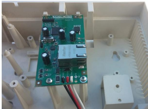
Рисунок 33. Коммуникатор «LanCom» rev.14 в корпусе прибора
