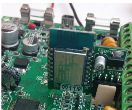
Рисунок 37. Установка модуля «W11M» в X3
