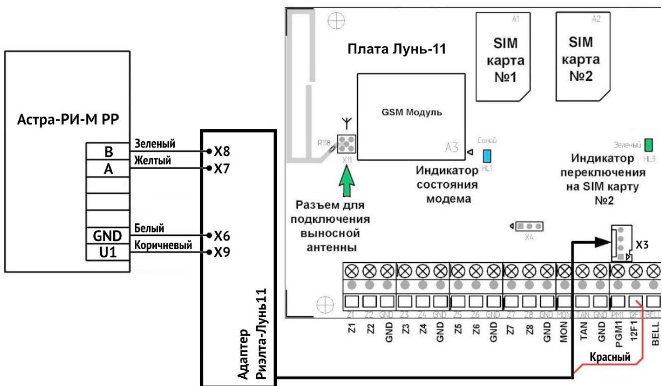
Рисунок 46. Схема подключения РПУ «Астра РИ-М РР»
