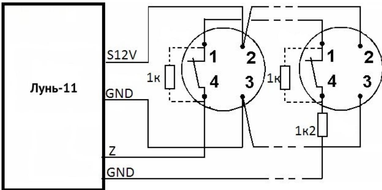
Рисунок 39. Схема подключения пожарных извещателей по четырехпроводной схеме
