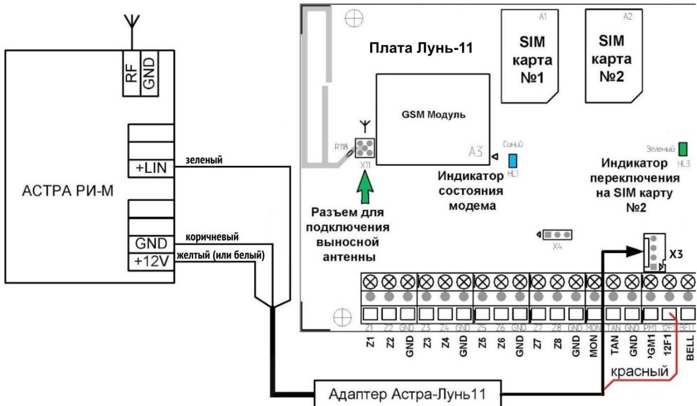
Рисунок 45. Схема подключения РПУ «Астра РИ-М»
