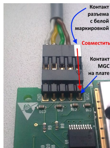
Рисунок 11. Подключение соединительного кабеля радиоприемника Visonic
