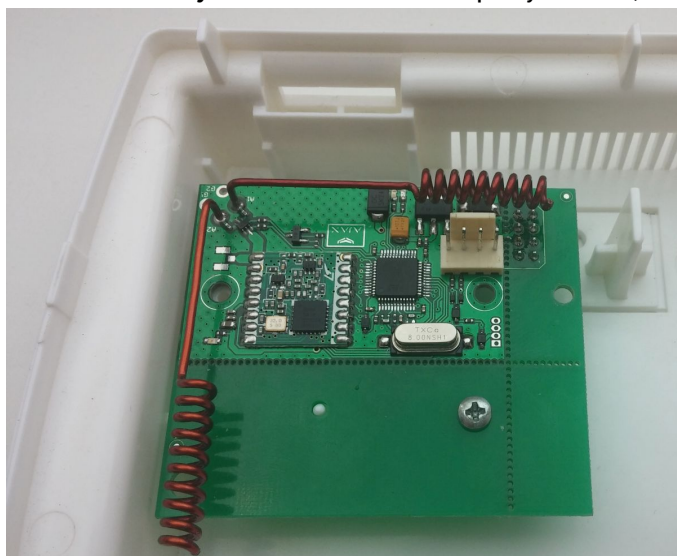
Рисунок 12. Радиоприемник Ajax «uartBridge» в корпусе прибора (без модуля WiFi)
