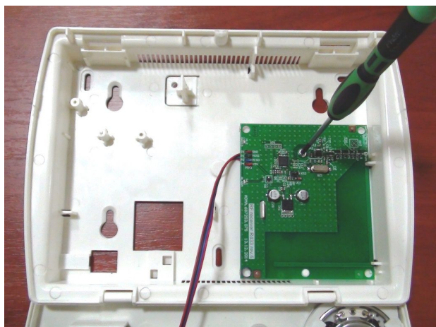
Рисунок 7. Установка радиоприемников серии «P433» в корпус «Лунь-19»
