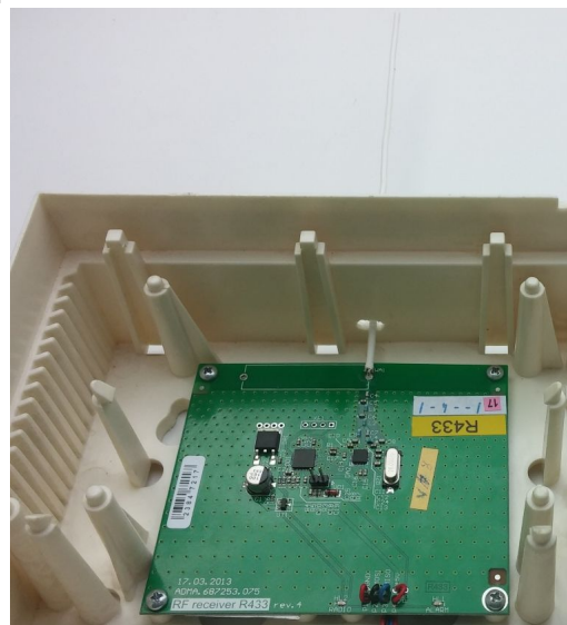
Рисунок 20. Радиоприемник «P433» rev.4 с антенной в корпусе прибора
