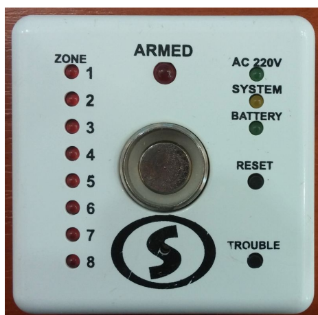
Рисунок 10. Внешний вид УИУ «Линд-11ТМ»
