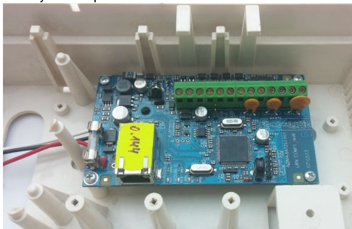
Рисунок 30. Коммуникатор «LanCom» rev.15 в корпусе прибора
