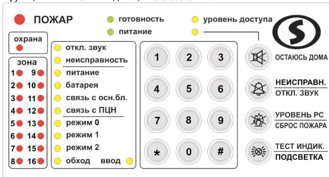
Рисунок 17. Внешний вид УИУ «Линд-9М3»
