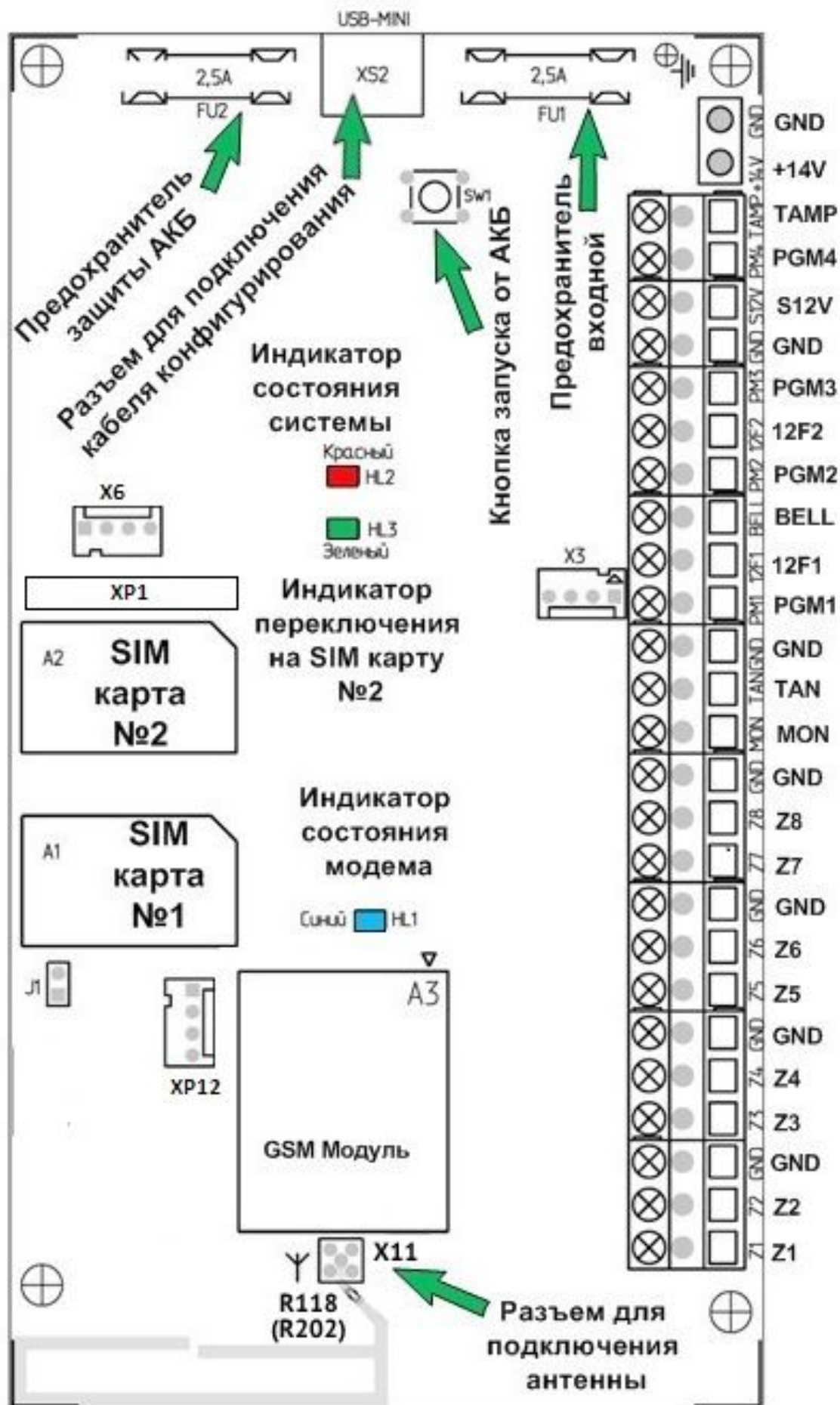
Рисунок 4. Внешний вид платы ППКОП
