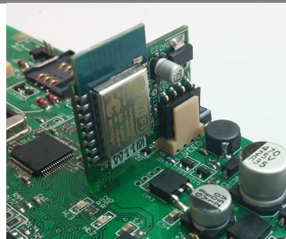
Рисунок 36. Установка модуля «W11M» в X6
