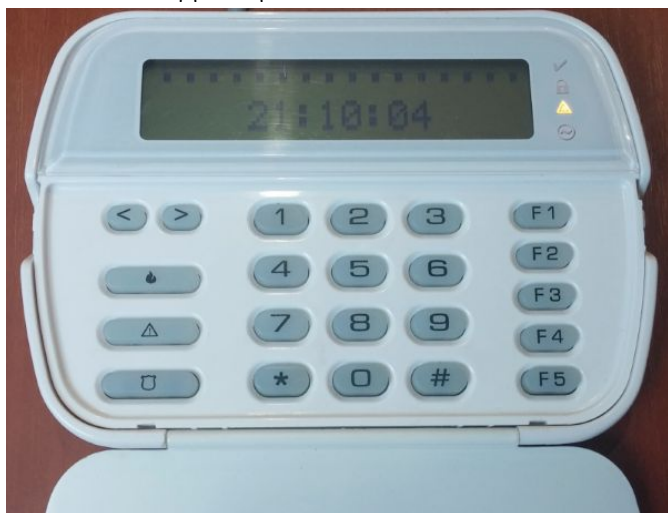
Рисунок 15. Внешний вид УИУ «Линд-11» с откинутой крышкой
