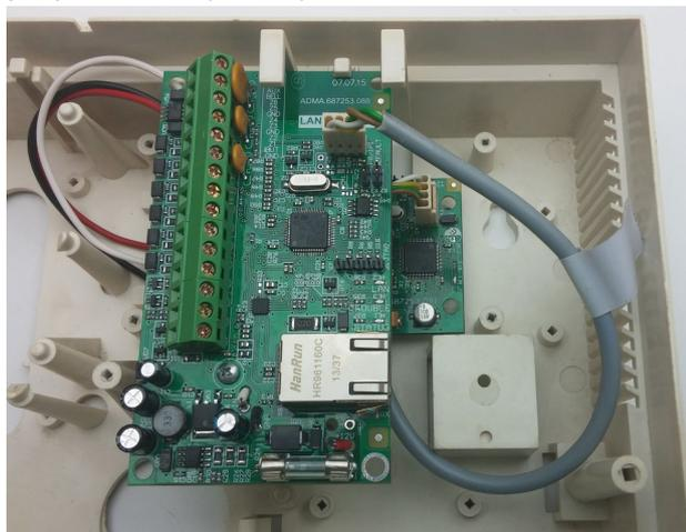
Рисунок 2. Установка «LanCom rev.15» с модулем «Дозор»
