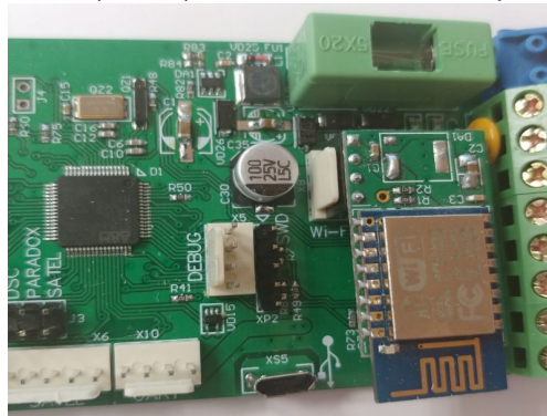
Рисунок 7. Установка WiFi модуля
