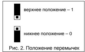
**Перемычки С1** и **С2** позволяют работать системе в любой аппаратной конфигурации (1 клавиатура + 6 зон модуля расширения, 2 клавиатуры + 4 зоны модуля расширения,
