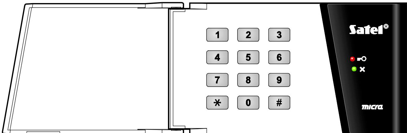
После выполнения определенных операций на клавиатуре (см.: раздел УПРАВЛЕНИЕ СИСТЕМОЙ ОХРАННОЙ СИГНАЛИЗАЦИИ), запросы на модуль MICRA отправляются по радиоканалу.
