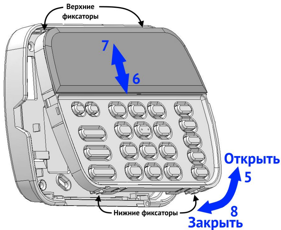
Рисунок 4. Извлечение клавиатуры
