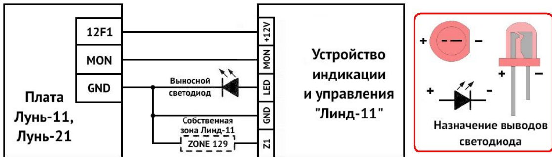
Рисунок 12. Схема подключения УИУ «Линд-11» к ППКОП
