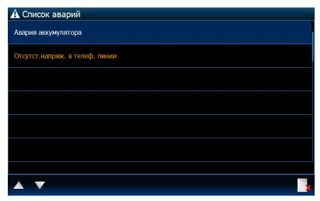
Отображение списка текущих аварий. Установщик может настроить прибор таким образом, чтобы аварии отображались до их удаления пользователем. Нажмите чтобы удалить память аварий.
