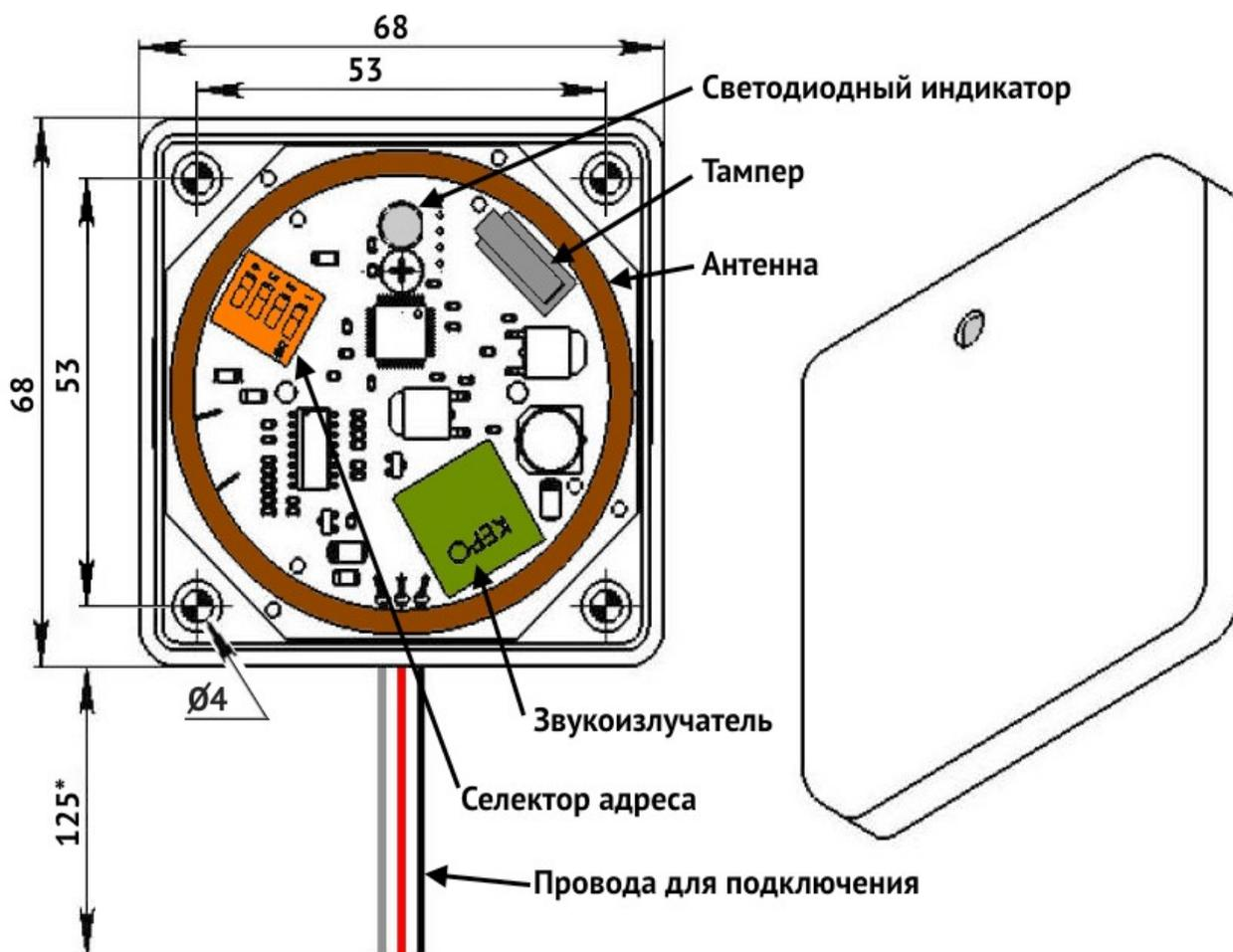
Рисунок 12. Считыватель «Линд-ЕМ»
