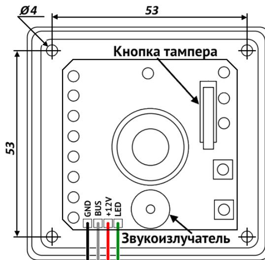
Рисунок 11. УИУ «Линд-8» со снятой крышкой
