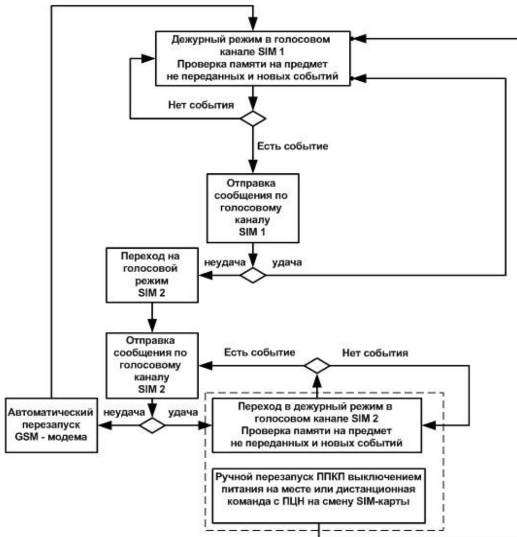
Рисунок 3. Использование канала связи Voice для 2-х SIM-карт
