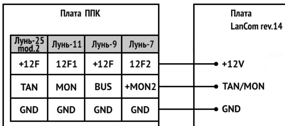
Рисунок 2: Схема подключения коммуникатора к ППК
