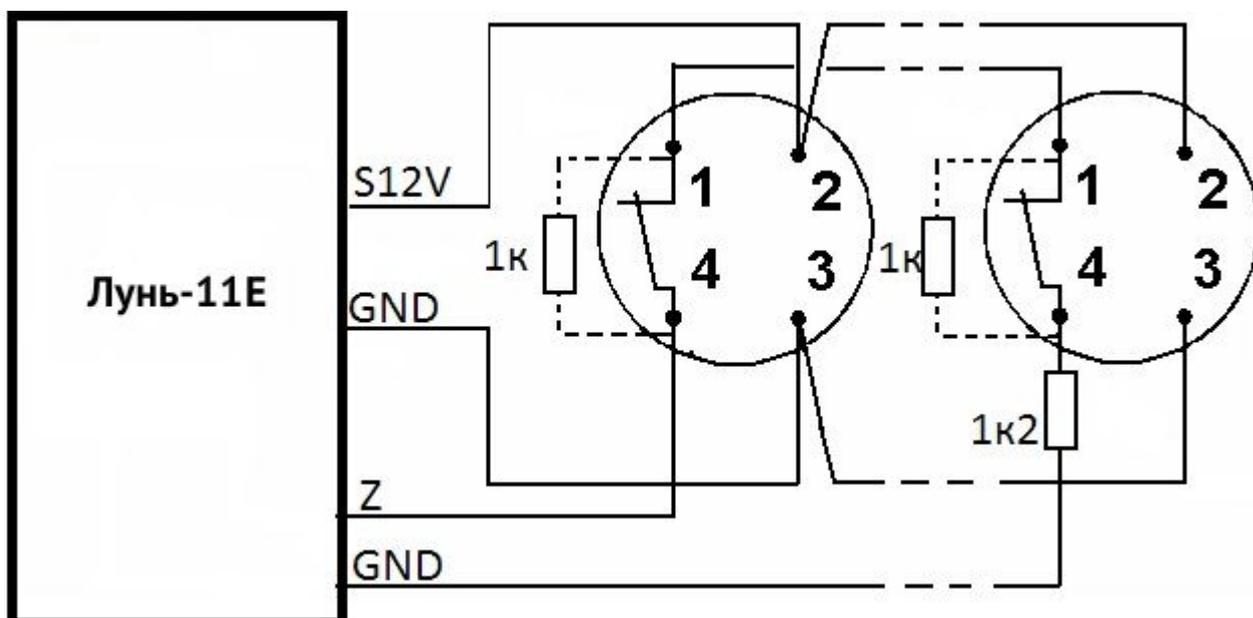
Рисунок 3. Схема подключения пожарных извещателей по четырехпроводной схеме
